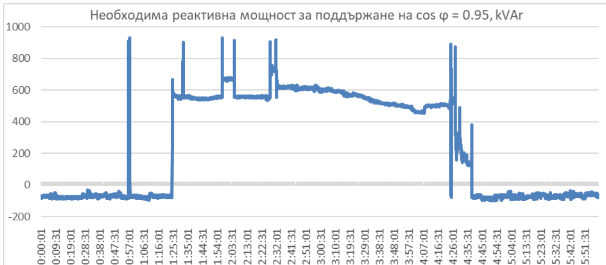
Фиг. 4 КРУ 1, килия №12 – необходима реактивна мощност
