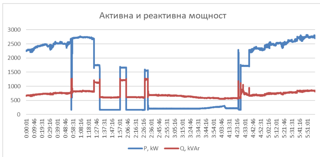
Фиг. 3 КРУ 1, килия №12 – активна и реактивна мощност на тигелна пещ
