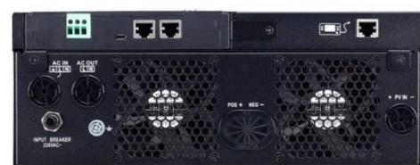
Фиг. 8. Охлаждане на хибриден инвертор SMV III 5kW (изглед
