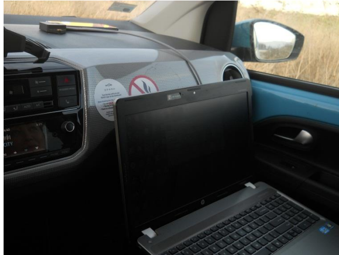
Фиг. 2. Акселерометър и мобилен компютър, използвани при експериментите
