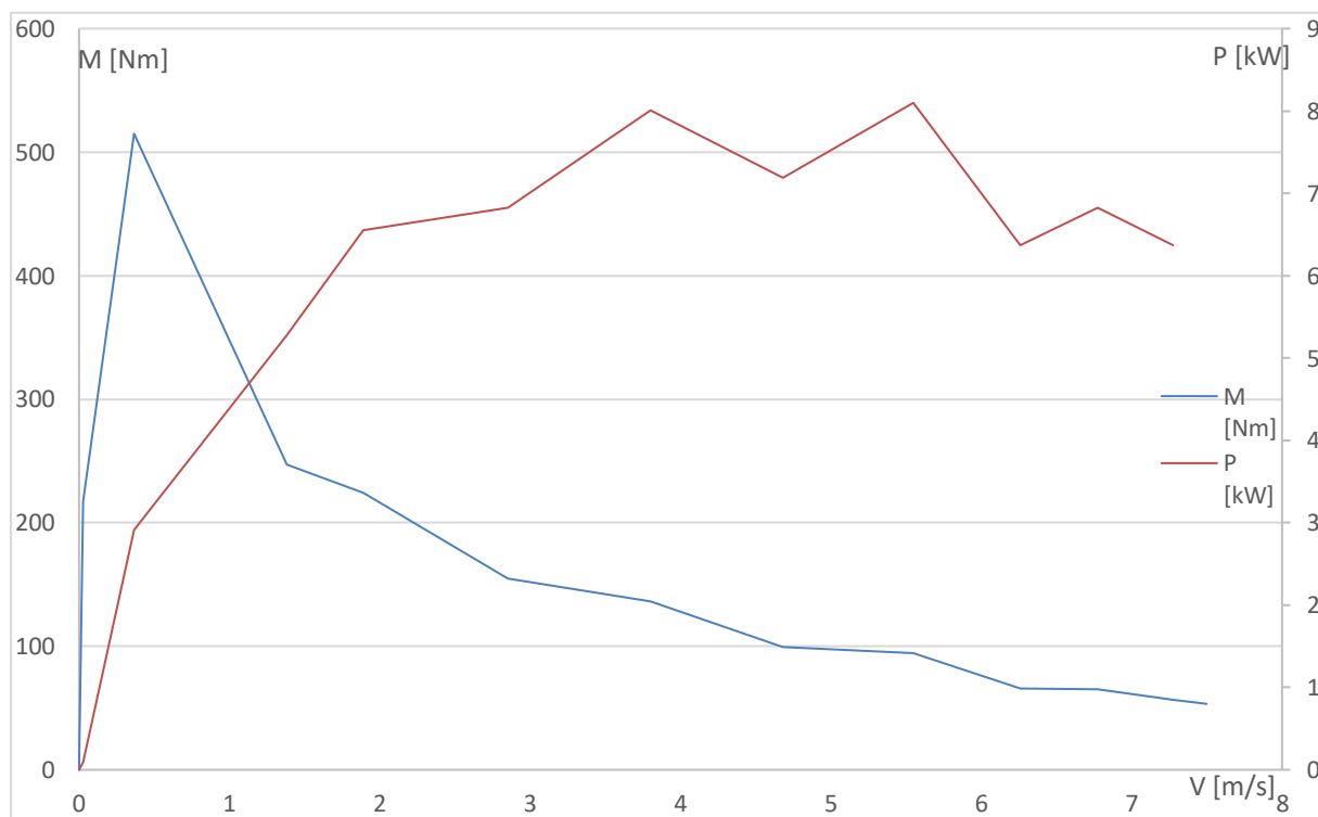
Фиг. 4. Момент и мощност на двигателя във функция от скоростта
