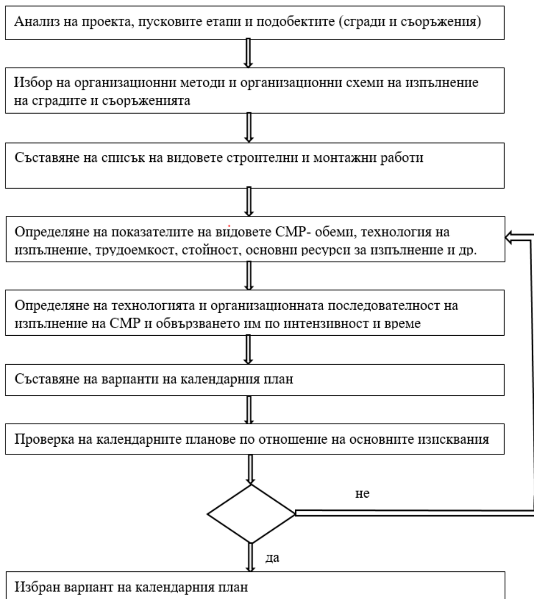
Фиг.1 Блок- схема на методическата последователност при съставянето на календарните планове в строителството
