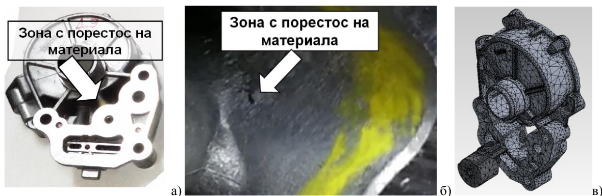
Фиг. 1. Изображения на изследвания образец (а), на визуално регистрирана пора в зона с теч (б) и на модела с условно разглобена зона с порестост (в).
