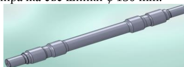
фиг. 7. Модел на ос с диаметър на шийката \phi 120 mm. фиг. 8. Модел на ос с диаметър на шийката \phi 130 mm.
