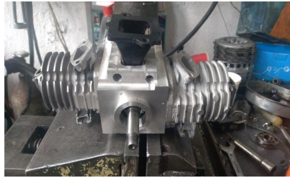
фиг. 5 Отвор на картерния блок за монтиране на карбуратор и бъдещото място на пластинчатия клапан
