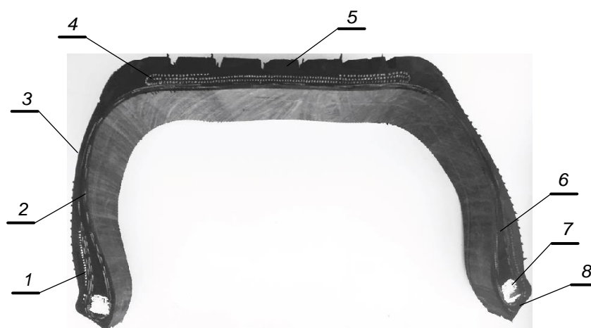
1 - металокордна усилваща лента; 2 - каркас; 3 - страница; 4 - металокорден брекер; 5 - протектор; 6 - напълнителен шнур; 7 - бортови обръч; 8 - борт
