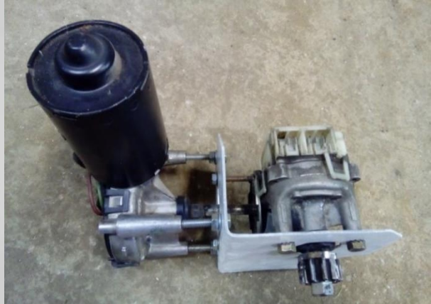
Фиг. 2 Електрозадвижване за насочване на ветрогенератор
