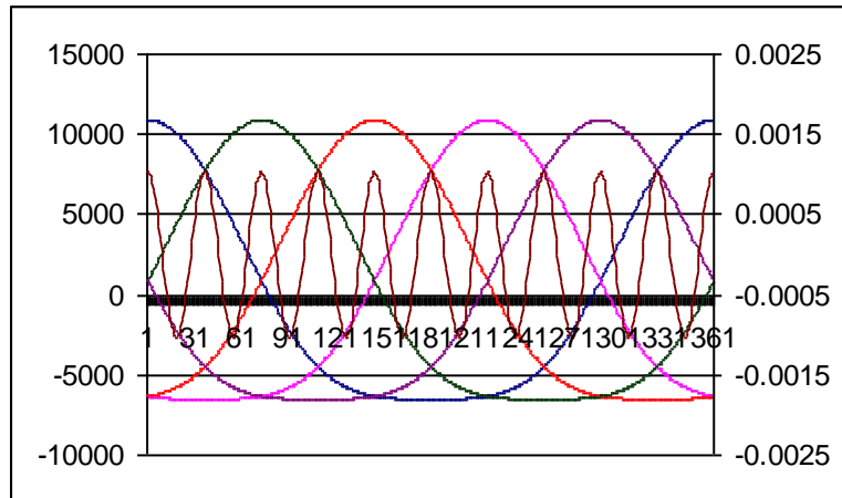
Фиг. 6 Изменение на инерционните сили предизвикани от възвратнопостъпателно движещи се маси във функция от ъгъла на завъртане на коляновия вал на 5-цилиндров редови двигател.
