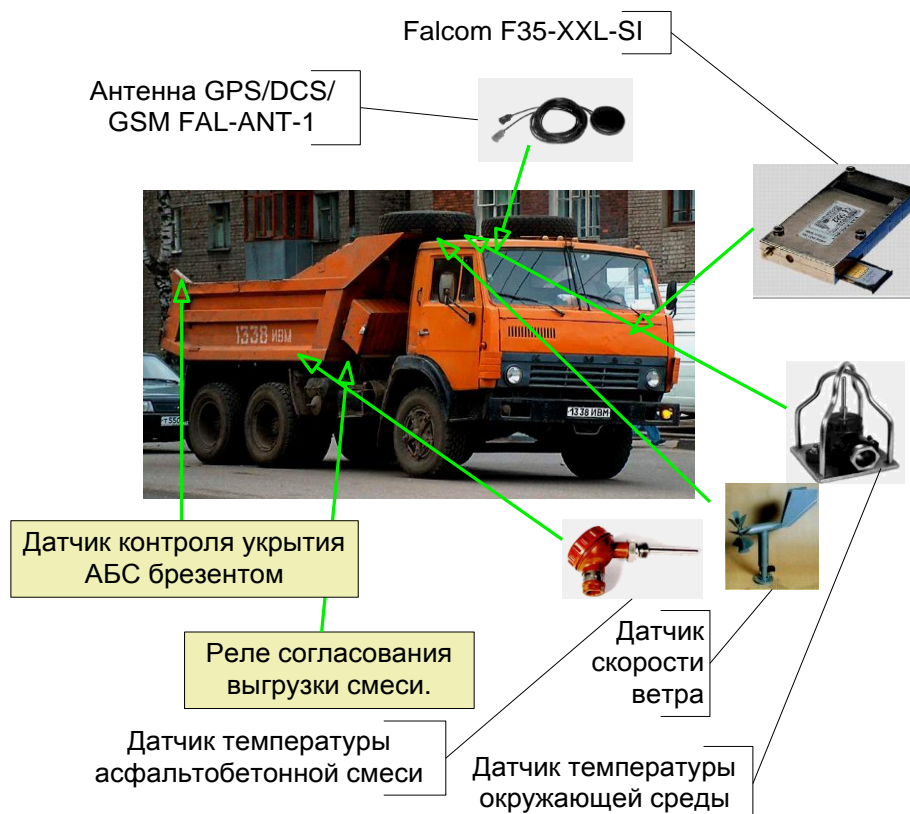
Рис. 4. Комплект оборудования транспортного средства, оснащённого системой GPS/ГЛОНАСС
