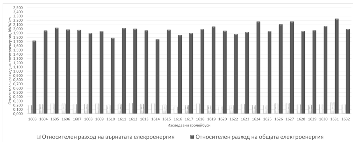
Фиг. 1. Графичен вид на общата и върната електроенергия на тролейбус Skoda 26 TR Solaris
