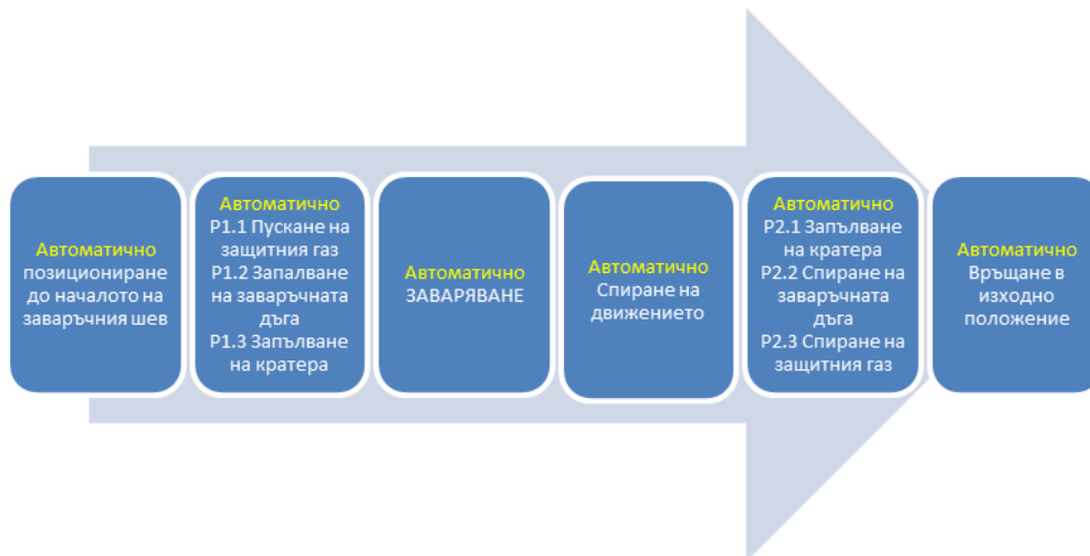
Фиг.7. Циклограма на процеса на автоматично заваряване на непрекъснат шев
