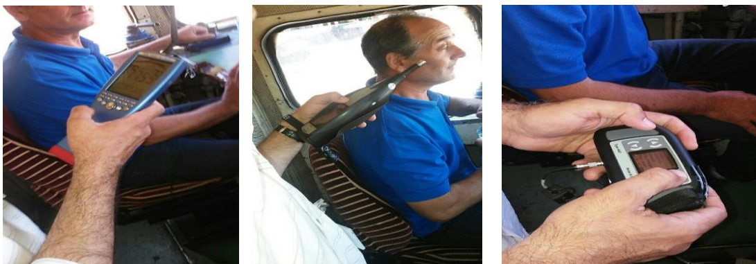
Фиг.1-3.Снимки от измерване на физическите опасности (електромагнитна радиация, вибрации и шум) в кабината на електрически локомотив
