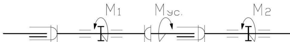
Фиг. 4. Моменти действащи на кардания вал.
