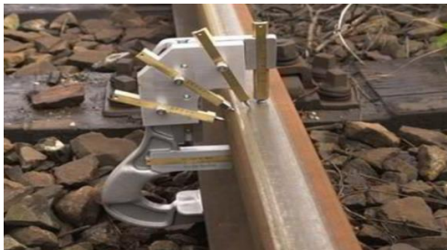
Фиг. 3 Определяне на износването с профилограф
