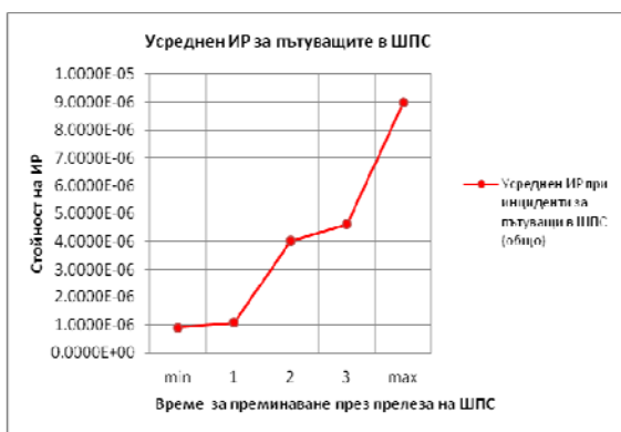
Фиг. 3. Усреднен ИР за пътуващите в ШПС при изменение на времето за преминаване на ШПС през прелез
