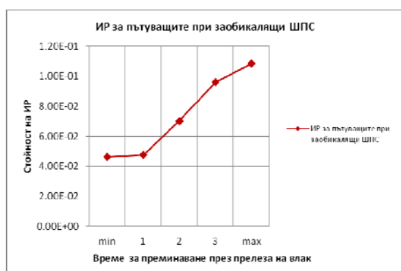
Фиг. 4. ИР при заобикаляне на бариерата от ШПС при изменение на времето за преминаване на влак през прелез
