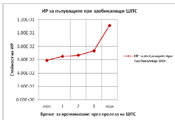
Фиг. 1. ИР при заобикаляне на бариерата от ШПС при изменение на времето за преминаване на ШПС през прелез
