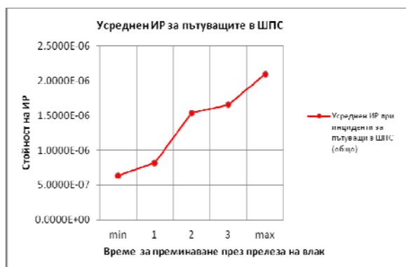
Фиг. 6. Усреднен ИР за пътуващите в ШПС при изменение на времето за преминаване на влак през прелез
