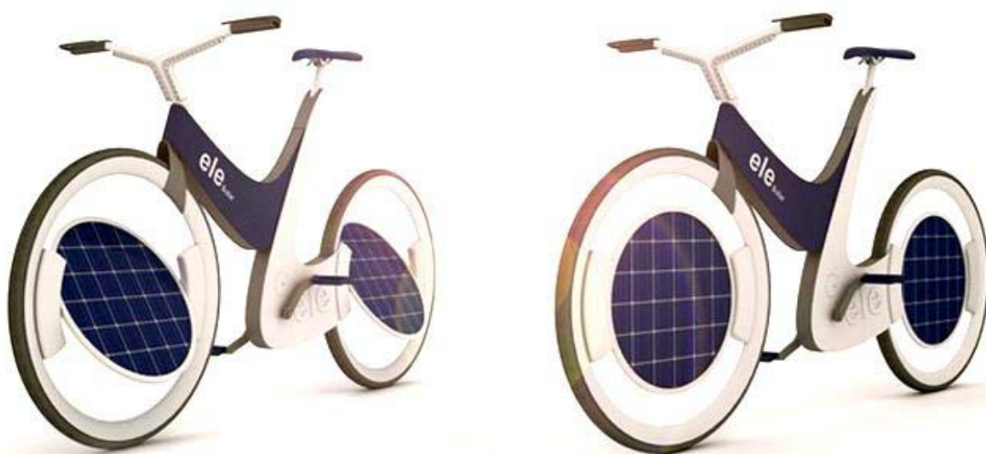
Фиг.5. Монтаж на фотопанел върху електровелосипед
