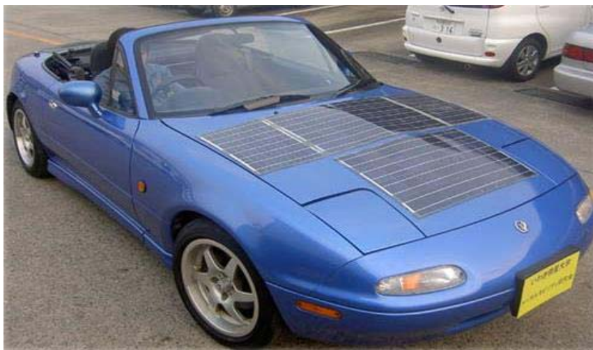
Фиг.2. Монтаж на фотопанел върху преден капак на електромобил
