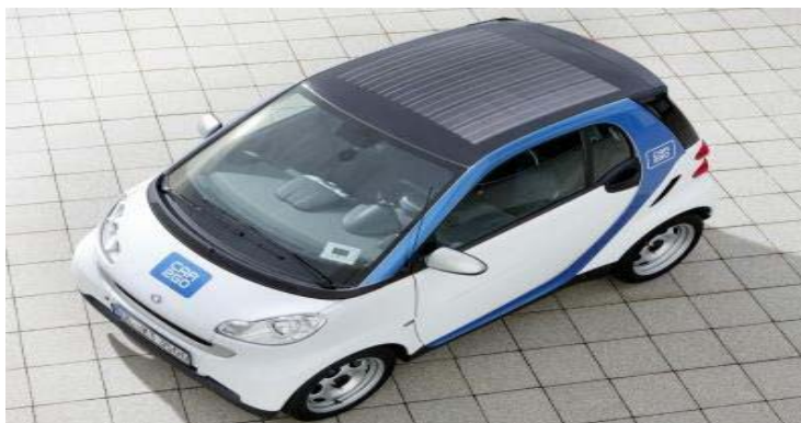
Фиг.3. Монтаж на фотопанел върху покрива на електроомобил
