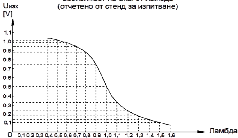
Фиг. 2. Характеристика на кислороден датчик BOSCH (цирконий оксид) - от стенда
