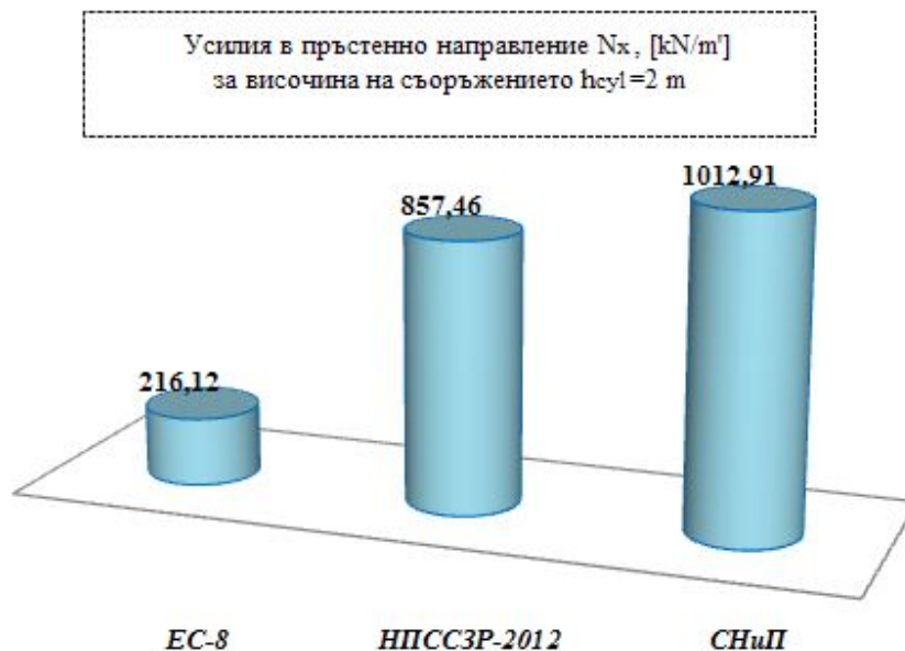
Фиг. 5 – *Извадка- разлики при резултатите за максималните разрезни усилия
