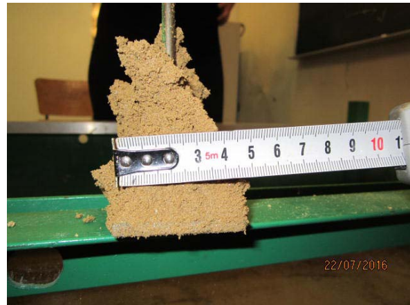
Фиг. 3. Изтръгнат обем почва присъединен към металната плоча а) при модел на фундамент с размери 10/10cm и дълбочини до 15 cm; б) при модел с размери 5/5 cm и дълбочина по-голяма от 15 cm.
