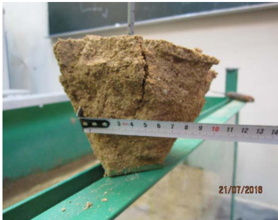
Фиг. 3. Изтръгнат обем почва присъединен към металната плоча а) при модел на фундамент с размери 10/10cm и дълбочини до 15 cm; б) при модел с размери 5/5 cm и дълбочина по-голяма от 15 cm.
