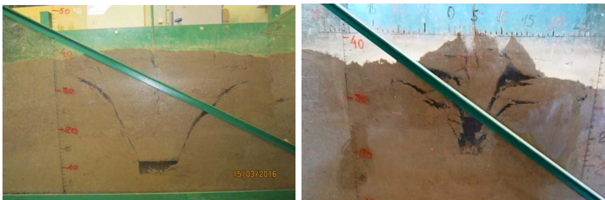
а) б) Фиг. 2. Получени очертания на повърхнини на разрушение а) при модел на анкер с размери 10/10cm; б) при модел с размери 5/5 cm.
