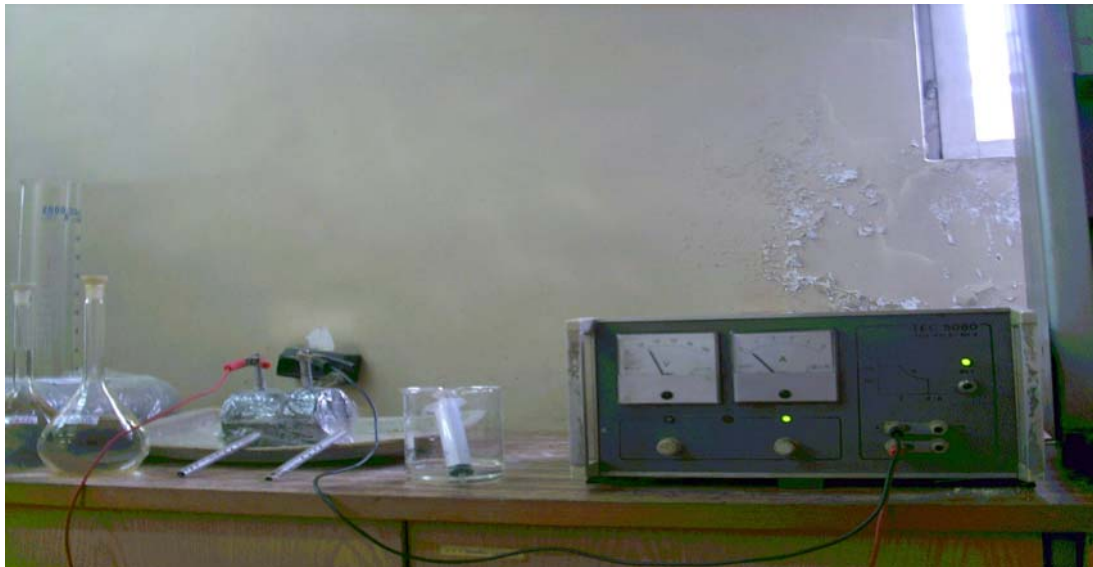
Фиг.1 Экспериментална постановка на електрохимичното заздравяване
