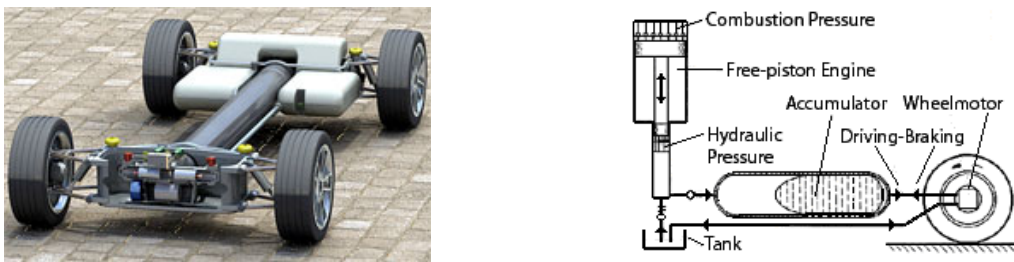
Фиг.5. Хибриден хидравличен автомобил на INGOCAR.
