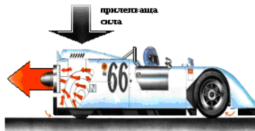
Фиг.10В Пътят на въздуха, изхвърлен от турбината
