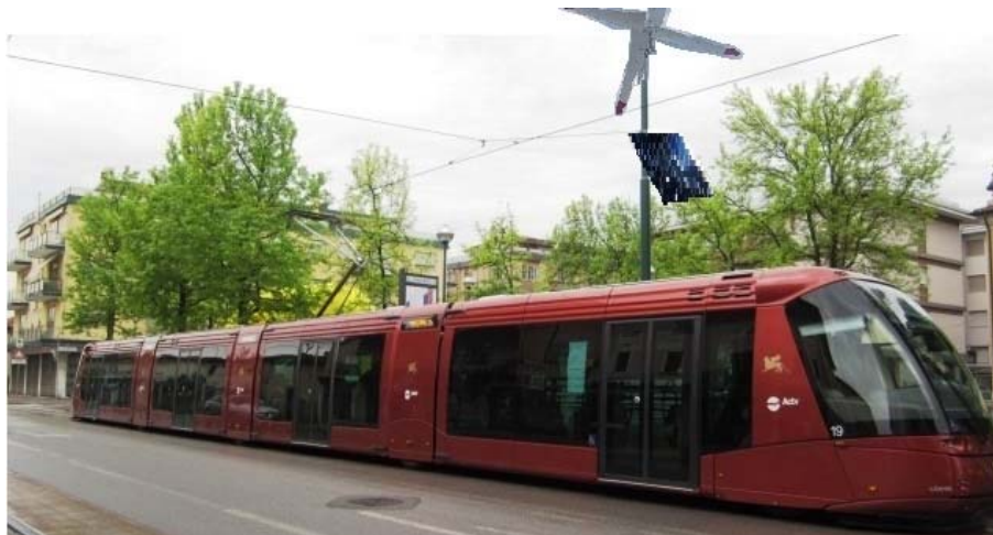
Фиг.1. Общ вид на ветрогенератора и фотоволтаичния панел монтирани върху стълб от контактната мрежа на градски електротранспорт.
