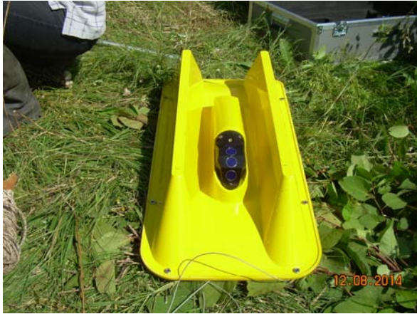
Фиг.8 Измерител ADCP измерителя -"Кубратово", София.
