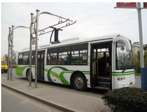
Фиг.2. Процес на заряд на електробуса в зареждащото поле
