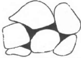
Фиг. 3 Баластови зърна при обработване със свързваща гъста консистенция
