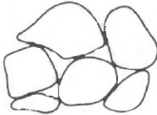
Фиг. 4 Баластови зърна при обработване със свързваща течна консистенция
