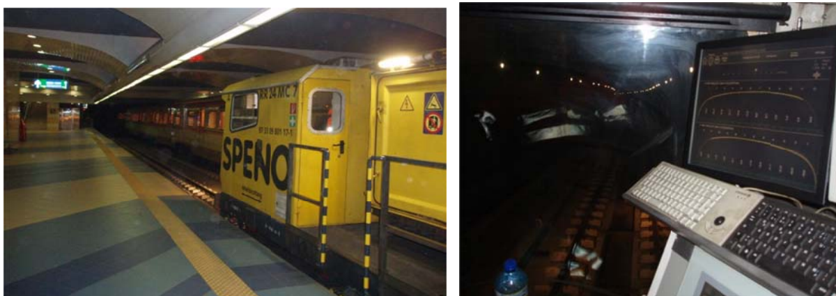
Фиг. 6 – машина за шлайфане на железен път на SPENO INTERNATIONAL
