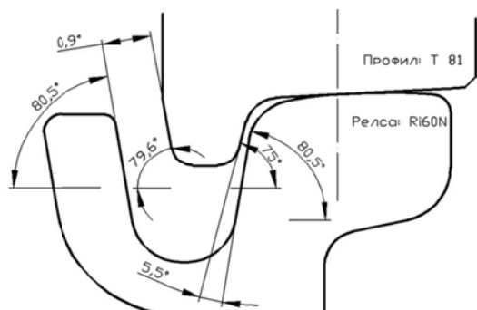
Фиг. 3. Контактни повърхности на реборда на колелото и реборда на релсата .
