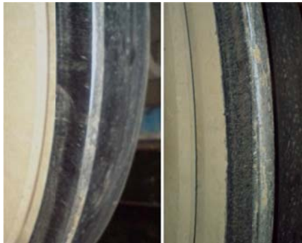
Снимка 1. „Високо“ износване на реборда (ляво) и начално (дясно).
