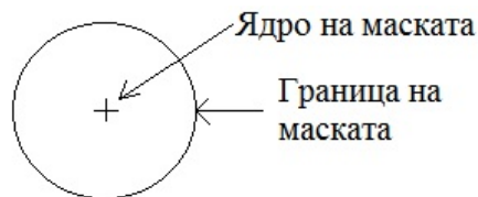
Фигура 3. Основни компоненти на маската, използвана в метода за откриване на ръбове SUSAN
