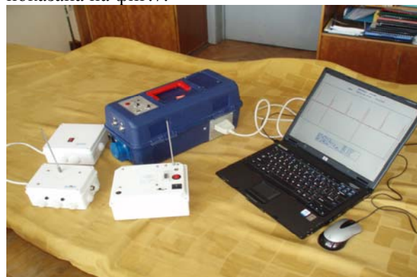
Фиг. 7 Реална измервателна система с радиодистанционно предаване на сигналите
