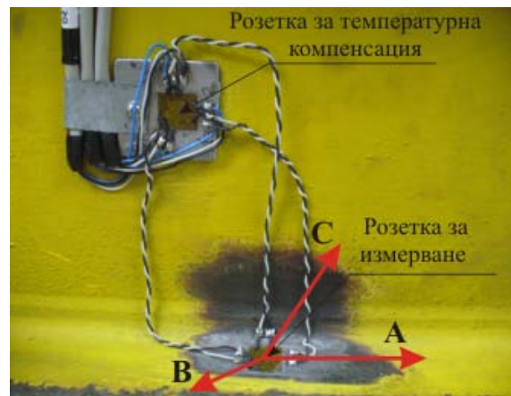
Фиг.2. Направления на тензорезисторите от розетката, спрямо моста
